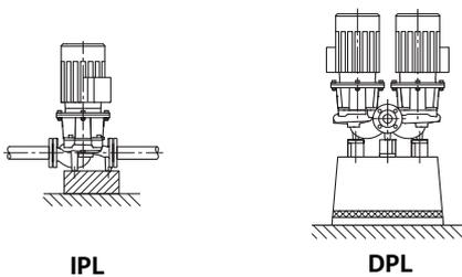
Рис. 10: IPL/DPL с горизонтальным расположением вала двигателя
