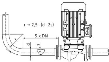
Рис. 9: Участок выравнивания потока перед и за насосом
